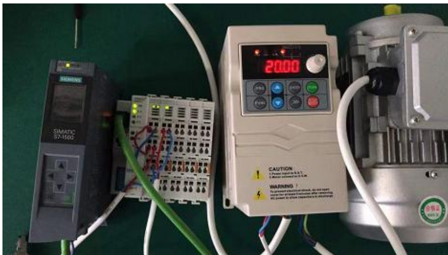
变频器正常工作在 20HZ
